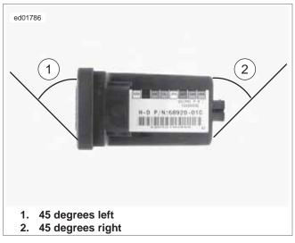
Figure 5-7. Tilting TSM/TSSM/HFSM
